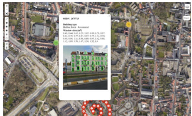
Sloopwijzer: een combinatie van expertise in materiaalbeheer, remote sensing, data science en AI. De demo tool die de automatische materiaalherkenning toont van een gebouw in Leuven.
